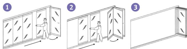
Con il sistema d'impacchettamento delle ante, in estate, il vano rimane utilizzabile come d'abitudine, senza parti fisse; in caso di vento, il vantaggio dei pannelli indipendenti è che si possono chiudere o posizionarli secondo l'esigenza, permettendo ugualmente l'aerazione del vano.
